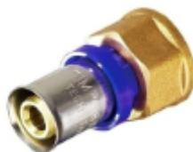
Пресс-фитинги для металлопластиковых труб - предназначены для создания, не разборных соединений трубопроводов из металлопластиковой и пластиковой трубы, диаметром (толщина стенки трубы): 16 (2) мм. Корпус пресс-фитинга, изготавливается методом горячей штамповки из высококачественной латуни с номинальным содержанием меди 58%. Пресс-гильза из нержавеющей стали. Штуцер фитинга имеет два уплотнительных кольца из EPDM.
